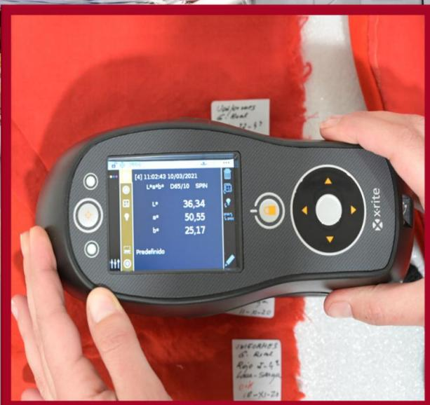
El espectrofotómetro es un dispositivo tecnológico que se usa para capturar y medir el color de manera objetiva, según el sistema universal CIE Lab o que permite, entre otras cosas, evaluar el color en los procesos de restauración textil.
